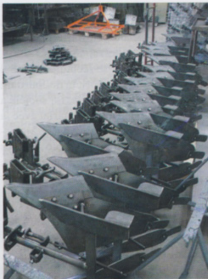
Un lot de brabants pour motoculteurs est terminé. Jourdant fabrique les Staub avec un attelage universel, pour les autres marques il s'agit souvent d'un attelage incorporé.
