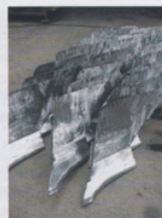
Le polissage est effectué sur toutes les pièces de labour pour réaliser un meilleur travail du sol. L'idéal reste de polir dans le sens de la terre afin que la pièce glisse mieux.
