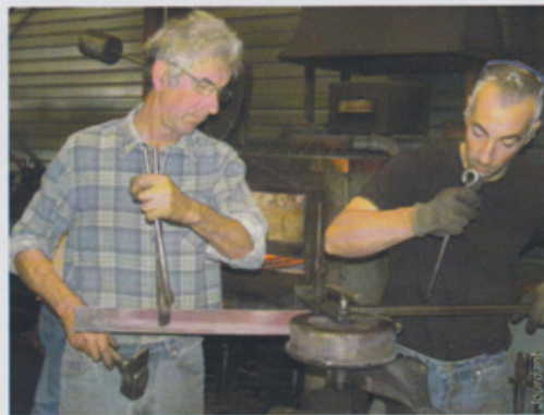
Le travail à chaud de l'acier avec le four et la mise en forme des pièces: ici Philippe Jourdant, à gauche, et Stéphane Parrain travaillent sur une roue.
